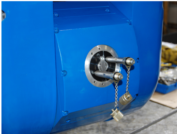
Anschlussverschraubungen an den Entlüftungsbohrungen der Spindel (Einbauposition)
