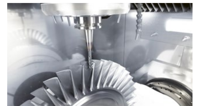
Dynamisches ultraschnelles Positionieren: Bearbeitung eines Flugzeug- Turbinenelements
